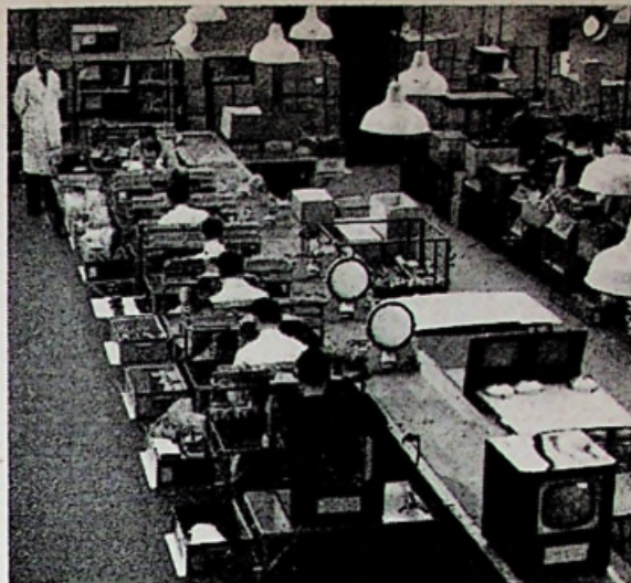
Een kijkje bij Van der Heem N.V., den Haag. Hier ziet men de fabricage van televisietoestellen aan de lopende band.
